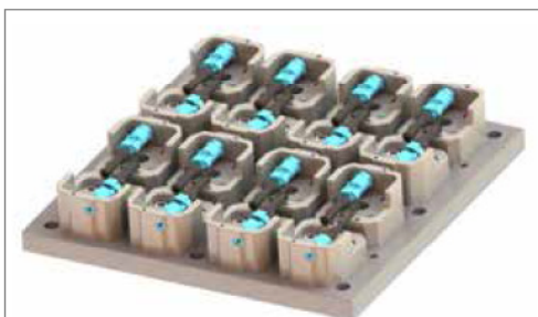
Der Testaufbau für den Vibrationstest entstand nach aufwändigen FEM-Simulationen und mehreren Designphasen.
