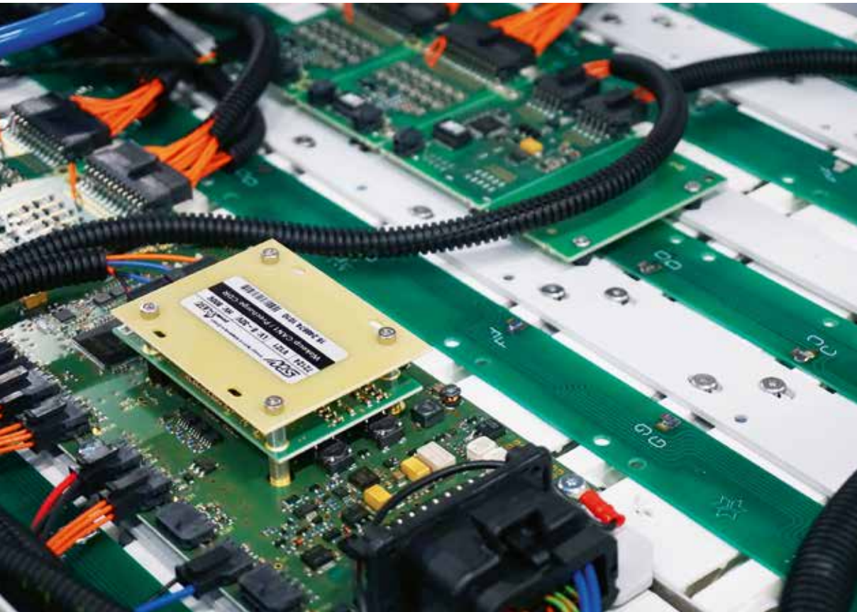
Einbauraum des mBMS von STW in der Kreisel-Batterie.
