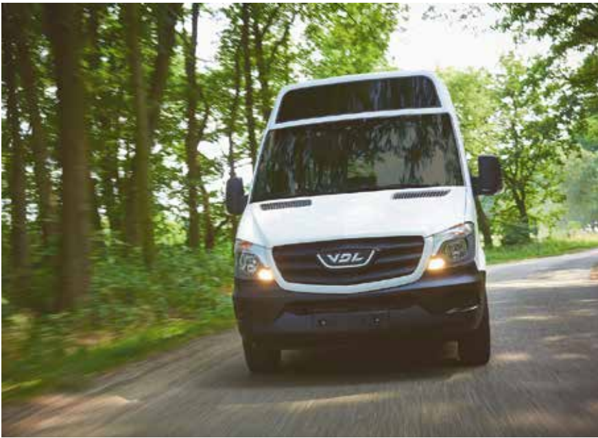
Bild 2: Der vollelektrische VDL MidCity Electric basiert auf dem Mercedes Sprinter und hat eine Reichweite von 220km. (© VDL Bus & Coach)
